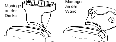
Abb. 7. Wandposition und Deckenposition des Haltewinkels
